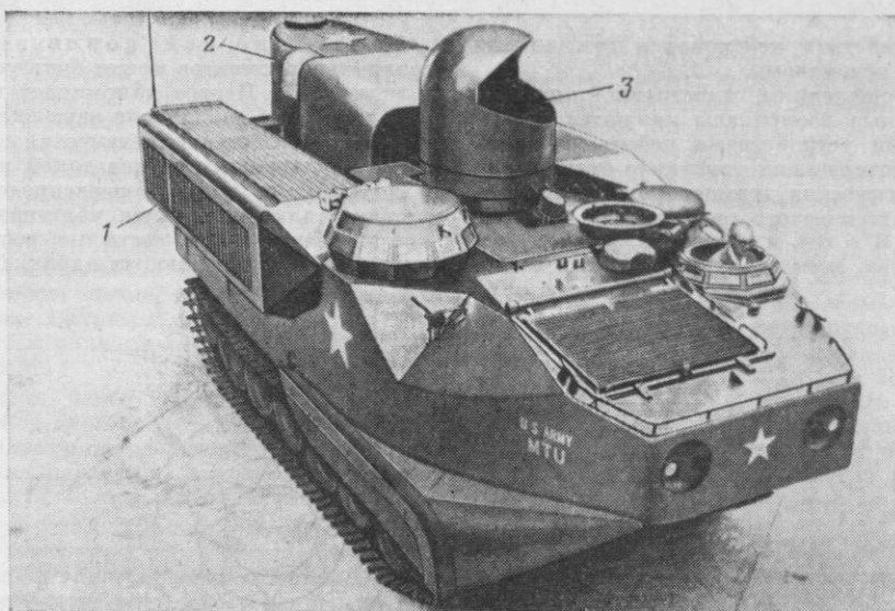
Рис. 3. Американская экспериментальная самоходная лазерная установка: 1 — радиатор системы охлаждения; 2 — генератор системы электропитания; 3 — система наведения лазерного луча
