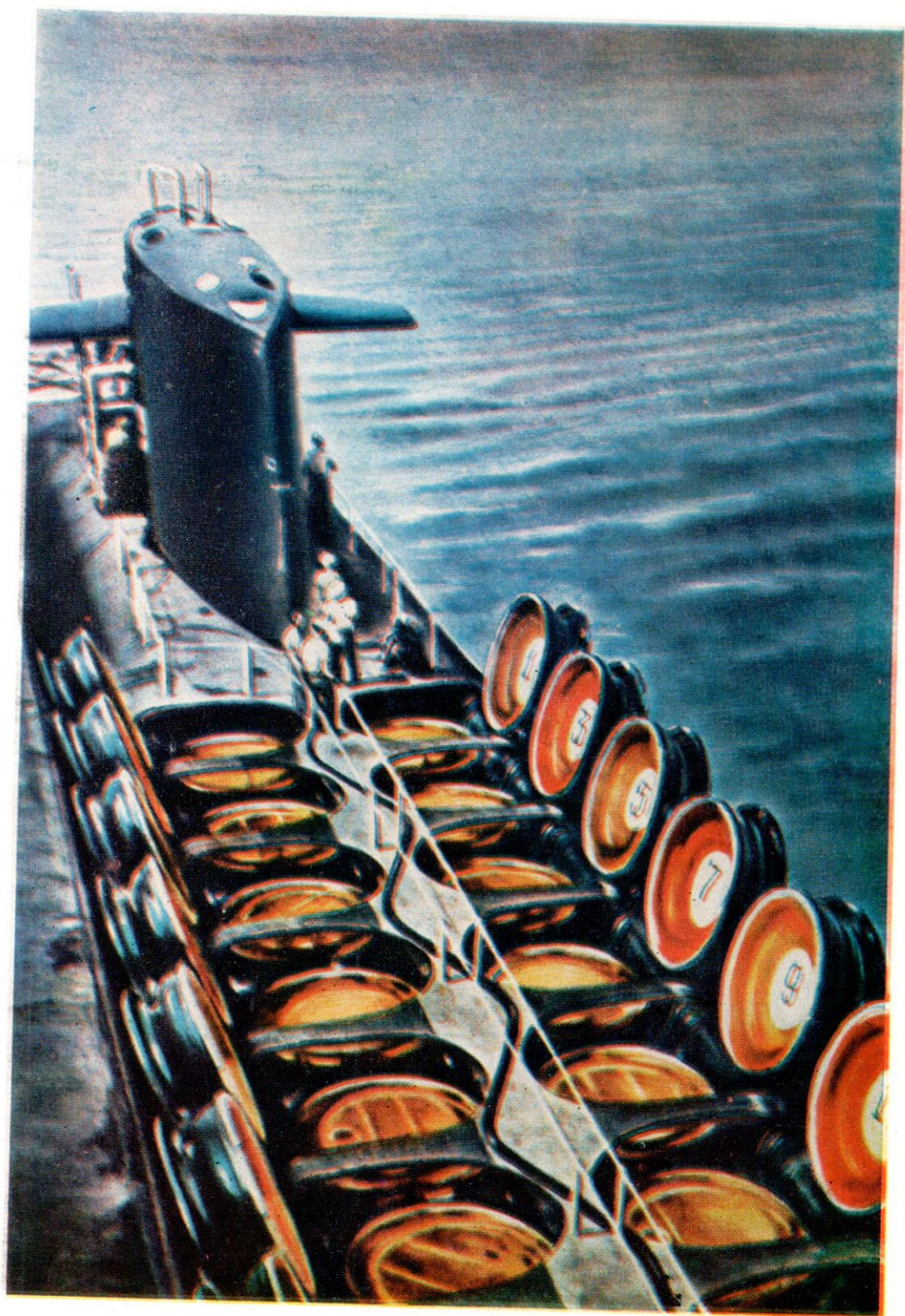
АМЕРИКАНСКАЯ АТОМНАЯ РАКЕТНАЯ ПОДВОДНАЯ ЛОДКА SSBN635 «СЗМ РЕЙН-БЕРН» (типа «Лафайет»). Ее водоизмещение надводное 7250 т, подводное 8250 т; длина 129,5 м, ширина 10,1 м, осадка 9,6 м; скорость подводного хода 30 уз; вооружение — 16 ракет «Посейдон»С3 и четыре 533-мм торпедных аппарата. Экипаж 168 человек, из них 20 офицеров
